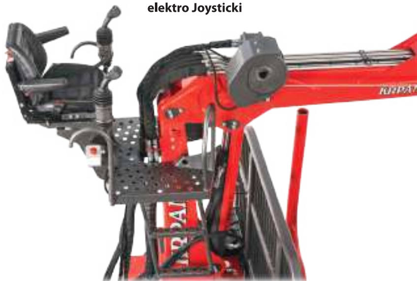
Visok sedež »Hochsitz« z proporcionalnimi elektro Joysticki
