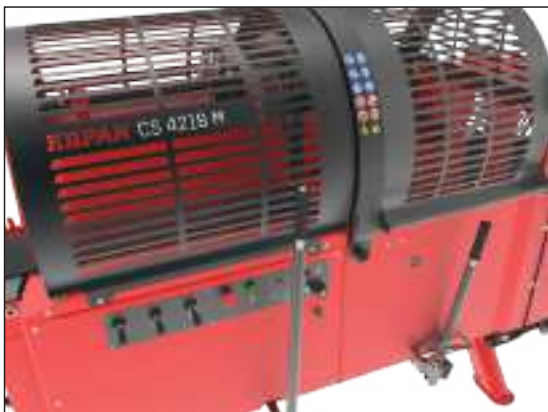
KR PAN CS 4218 M je vstopni model z enostavnim mehanskim krmiljenjem
